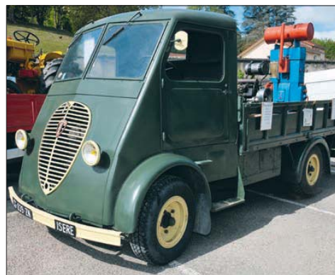
◀ Jean-François Ferlin présente le Peugeot Q3A de 1949, petit camion léger (2 t à vide pour 2 t de charge utile) et un moteur fixe Bernard W112. Le Q3A est équipé du même moteur 1 290 cm 3 que la berline 203.
